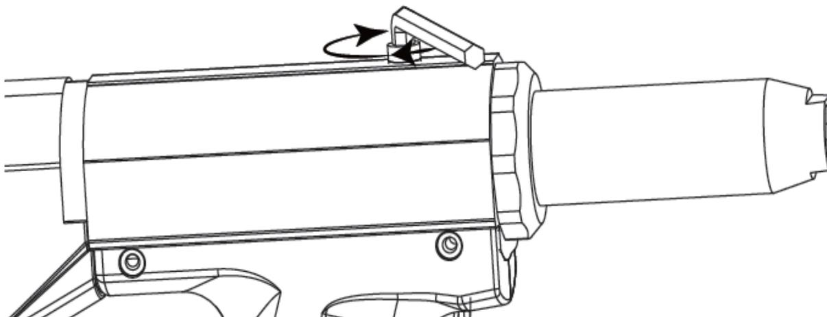
После длительного использования инструмента в его носовой части может скапливаться металлическая стружка от заклепок, что может снизить эффективность работы инструмента. Поэтому рекомендуется периодически очищать или заменять расходные детали носовой части инструмента.
