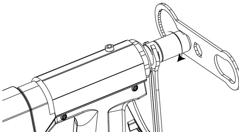
5) Вытащите *губки* (4) из *патрона* (3); достаньте *толкатель* (5), *пружину толкателя* (6) и *оправку* (20) из инструмента; почистите все эти детали или при необходимости (по мере износа) замените их на новые:
